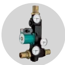
Reglerpaketet "Laddomat 21" är utrustad med termisk ventil för god skiktning i tanken.
